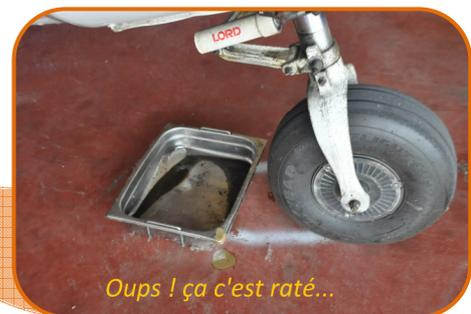
La cause est très simple, soit on oublie de placer les petits bacs sous les Cessna 150, soit on ne les dispose pas correctement. La position correcte est derrière et **contre** la roue de nez et **légèrement sur la droite** par rapport à l'axe de l'avion étant donné que le reniflard se trouve sur le côté. Il suffit de bien regarder que le bac soit juste en dessous de ce reniflard. Les instructeurs et examinateurs sont instamment priés d'y veiller en instruisant leurs élèves dans ce sens.
