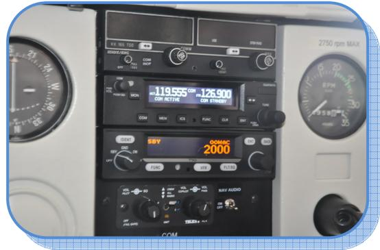
Le WAC est passé sur la balance, car selon la réglementation, cette opération doit être faite tous les 10 ans. Ce sympathique petit Cessna a reçu une nouvelle radio (8,33 obligatoire) et un transpondeur mode S. Ce qui fait de lui un appareil bien équipé pour les navigations, notamment en espaces contrôlés.
