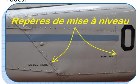
Vous avez peut-être déjà remarqué lors de votre visite pré-vol ces deux vis qui débordent de la surface sur un côté du fuselage. Elles sont ainsi disposées dans le but de servir de repères pour la mise à niveau de vol. Un technicien se place face à elles avec un niveau à bulle qu'il pose au-dessus de ces deux marques contre le fuselage.
