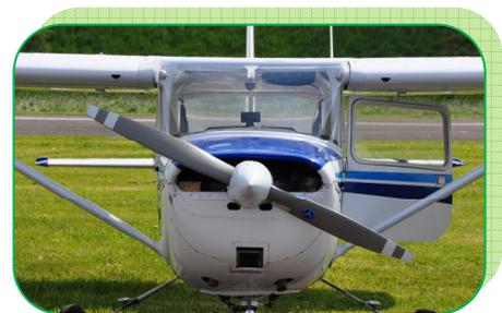
NB : pour un C172 muni d'une hélice de 1,91 m de diamètre, on obtient 899 km/h pour 2500 tr/min. et 972 km/h pour 2750 tr/min.
