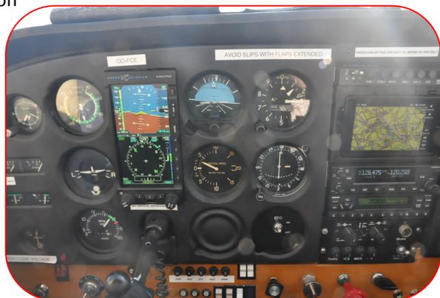
La partie supérieure de l'instrument représente l'horizon artificiel entouré d'une bande indiquant la vitesse sur la gauche, d'une bande concernant l'altimètre sur la droite et d'un indicateur de coordination de virage dans le haut.
